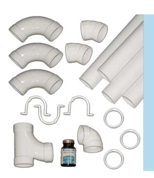
Монтаж системы трубопроводов встроенного пылесоса происходит с помощью прокладки специальных труб, отводов и тройников из ПВХ, которые имеют антистатическое покрытие и соединяются с помощью специального клея
